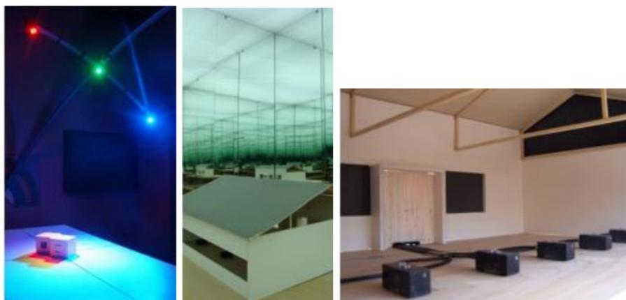
El simulador solar sirve para evaluar el efecto de la trayectoria del sol en modelos físicos arquitectónicos o urbanísticos. Permite una visión tridimensional del comportamiento del sol frente a los edificios. El cielo artificial es un dispositivo destinado a simular condiciones de cielo CIE cubierto con el objetivo de evaluar la iluminación natural en maquetas.
