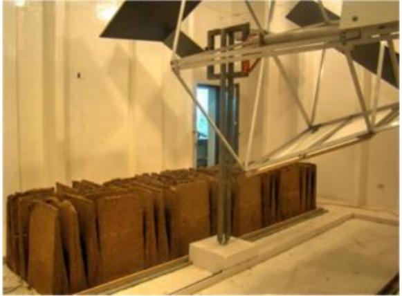
*Cámara de reverberación:* ISO 354 – IRAM 4065. Se utiliza principalmente para medir: coeficientes de absorción de materiales, potencia acústica en campo aleatorio o difuso.
